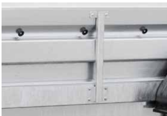
Cztery wzmocnienia burt w standardzie w modelach 300 SU, 300 T i 330 T
