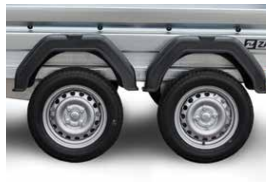
Zastosowano dwie osie 750 kg firmy KNOTT
