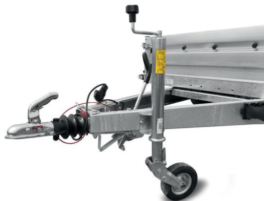
KOŁO PODPOROWE automatyczne KNOTT Nośność: 300 kg, Średnica rury 60 mm, Wysokość: 65 cm, Maksymalny wysuw: 22 cm
